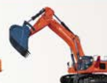
Экскаватор Профессионал PB950 Эксплуатационная масса 915 м Средний вылет 25 м Шасси: МР50 Максимальная мощность 505 кВт
