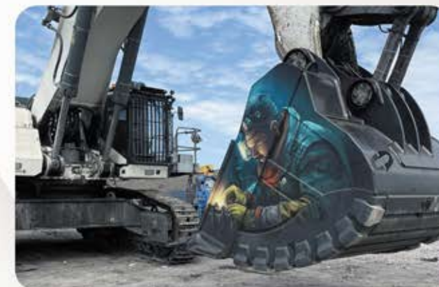
КОВШ 30-ТЫСЯЧНЫЙ ОБРАТНАЯ ЛОПАТА ДЛЯ ЭКСКАВАТОРА LIEBHERR R9150 ОБЪЕМ – 8,5 КУБ.М
