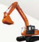
Экскаватор Профессионал PB225N Эксплуатационная масса 218 м Средний вылет 11 м Шасси: Салон 800x125-С100 Максимальная мощность 102 кВт
