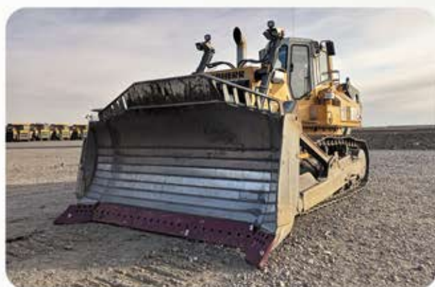
ОТВАЛ ПОЛУСФЕРИЧЕСКИЙ ДЛЯ БУЛЬДОЗЕРА LIEBHERR 784 ОБЪЕМ – 13,7 КУБ.М
