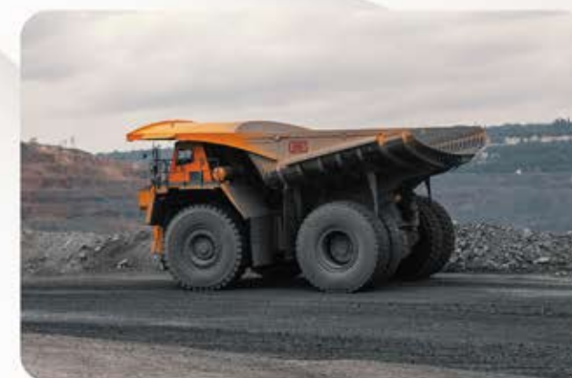
КУЗОВ ДЛЯ САМОСВАЛА БЕЛАЗ 75309 ВЕС С ФУТЕРОВКОЙ - 38 ТОНН ОБЪЕМ – 140 КУБ. М
